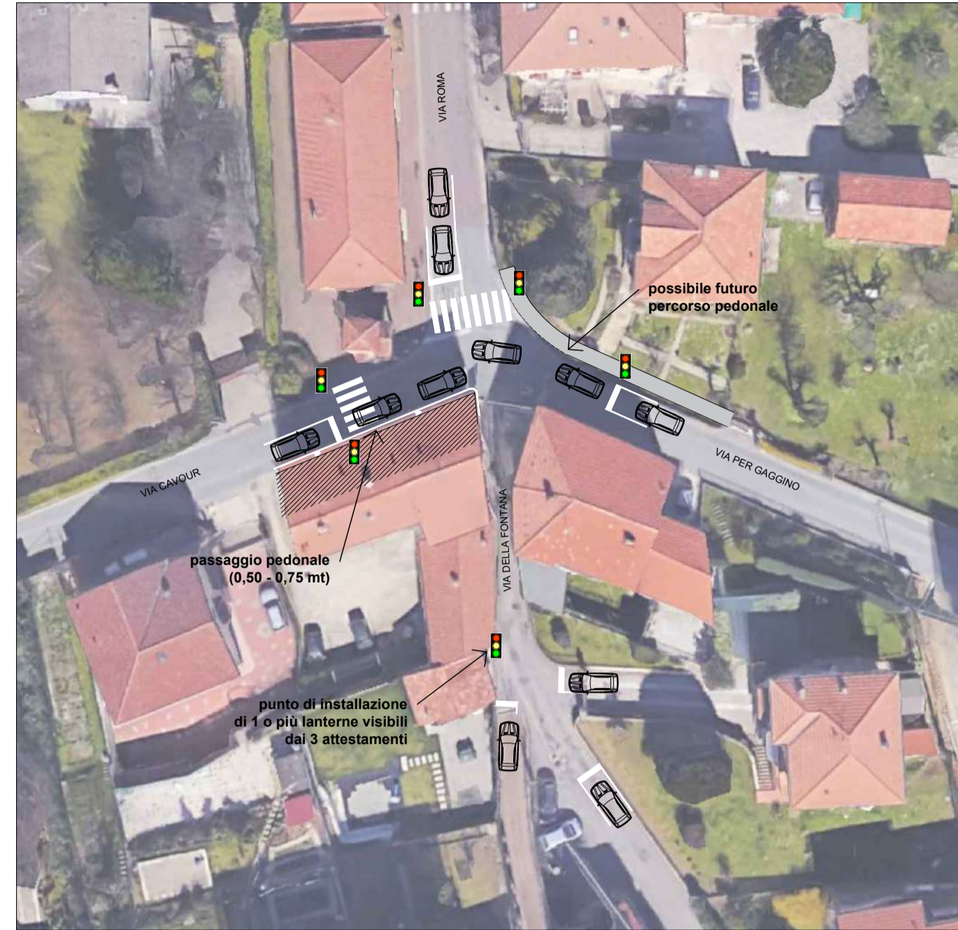
1A - SP17/VIA ROMA/VIA DELLA FONTANA - INSERIMENTO DI UN IMPIANTO SEMAFORICO A 3 FASI (IPOTESI 1)
